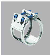
Trekk til de to boltene vekselvis med f.eks. en skralle-/fastnøkkel. Tiltrekkingmoment min 20 Nm.
