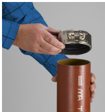
Skyv på JETETT®/Ultrajet®-koblingen slik at midtrillen treffer rørenden.
