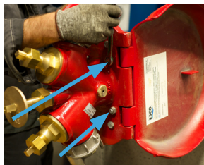
2. Løsne de 4 innerste boltene
