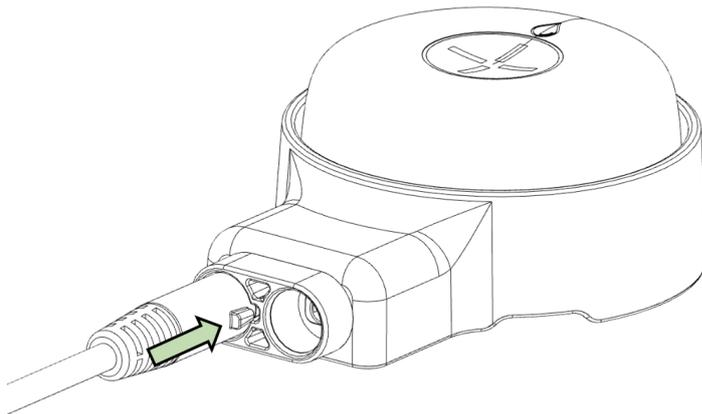
Dytt kontakten helt inn. BS! Braketten er laget med forsegling for å beskytte kontaktpunktene mot vanninntrengning. Det kreves derfor noe mer kraft enn normalt.
