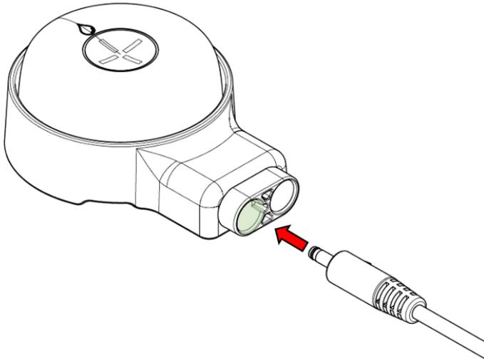
OBS! For å unngå at feil strømadapter benyttes (eller at kontaktpunktene forveksles) er kontakten til strømadapteret laget med en liten tapp som passer til sporet i venstre kontaktpunkt. Påse at denne tappen er posisjonert riktig før tilkobling.
