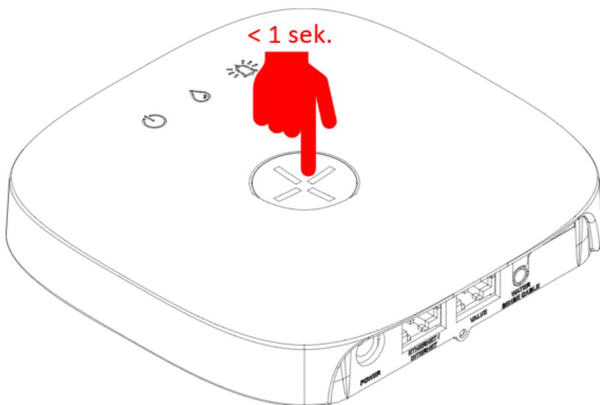
Etter sensorene er tørket og årsaken til alarmen er utbedret, kan du åpne ventilen igjen ved å trykke på Linkbox-knappen i 3 sekunder. **NB! Ikke åpne ventilen før du er helt sikker på at lekkasjen eller årsaken til vannsølet er fjernet.**
