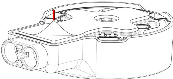
2. Tilpass indikatorlinjen på sensoren til indikatorlinjen på braketten og sett sensoren inn (Step 1).
