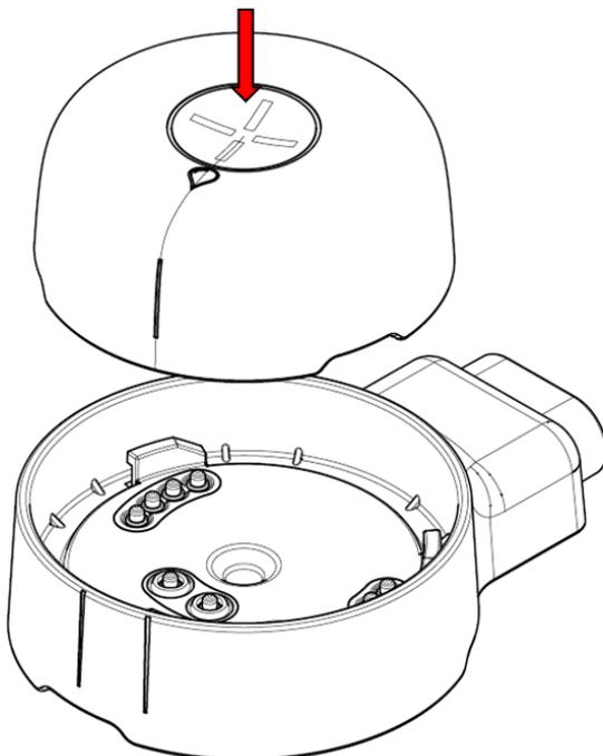
3. Vri sensoren med klokken til et merkbart "KLIKK". Sjekk at indikatorlinjen peker på LUKKET posisjon (Step 2).
