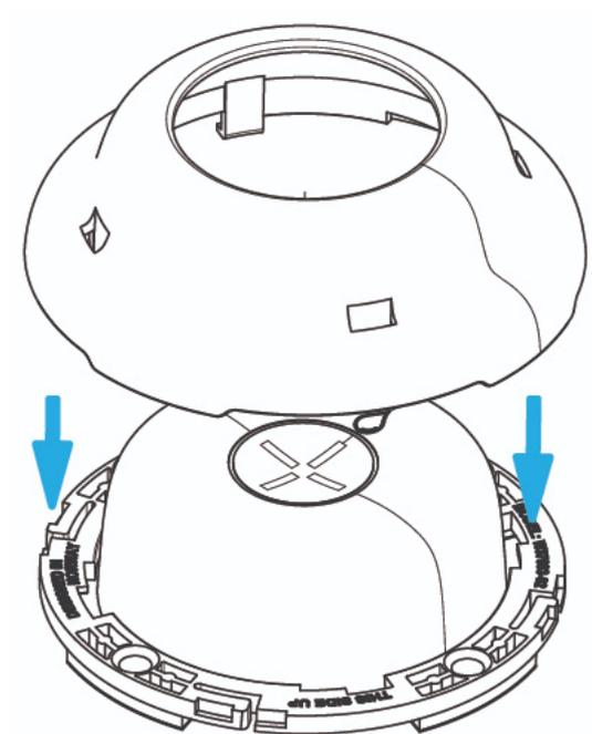
3. Vri dekselet i pilens retning for å låse. Du vil høre og kjenne et "klikk" når dekselet sitter på plass. Lås opp dekselet ved å dreie i motsatt retning.
