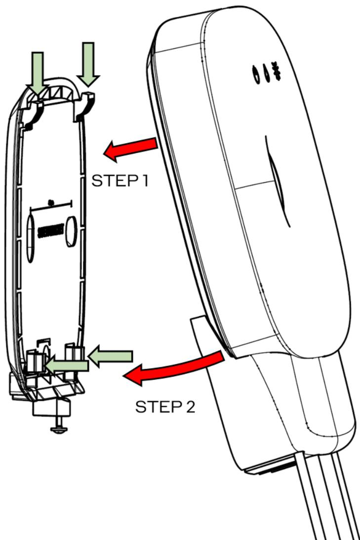
5. Bruk en Philips PH1 or PH2 skrutrekker til å stramme festeskruen i underkant a braketten. Skruen sikrer at Linkbox+ ikke løsner fra braketten utilsiktet ved vibrasjoner eller støt.
