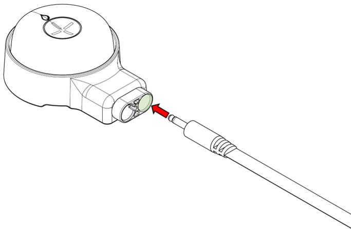
2. Dytt kontakten helt inn. OBS! Braketten er laget med forsegling for å beskytte kontaktpunktene mot vanninntrengning. Det kreves derfor noe mer kraft enn normalt for tilkobling av 3.5 mm jack-plugg.
