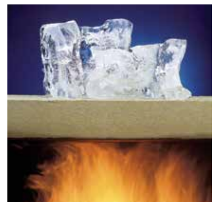
Steinull beholder sine egenskaper ved så høye temperaturer som 1000 °C og gir derfor en god passiv brannbeskyttelse.
