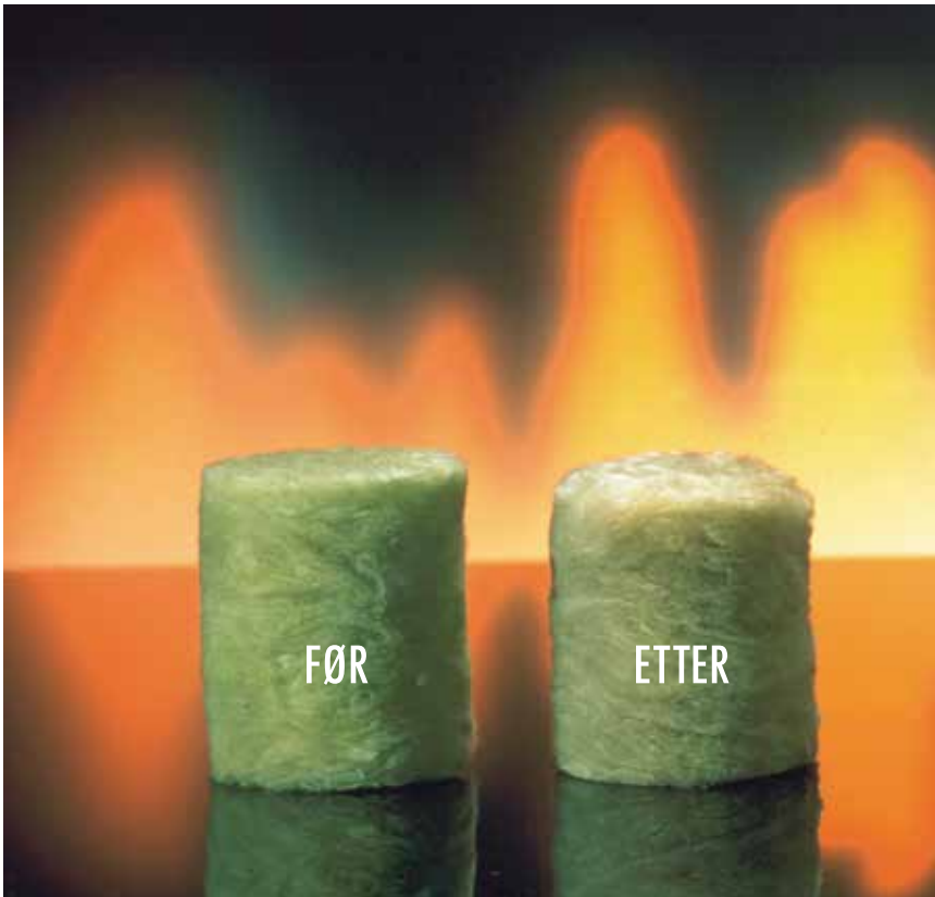
Paroc® Steinull motstår svært høye temperaturer. Bildene viser et eksempel på PAROC® Steinull før og etter en branntest iht. EN ISO 1182, der testgjenstanden utsettes for en temperatur på 750 °C.
