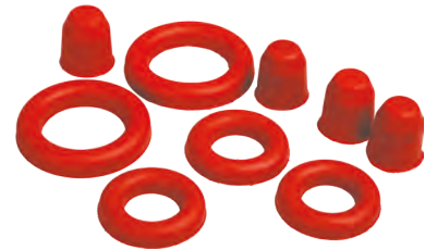
SikaSwell A plugger og ringer er tetningsprodukter spesielt beregnet for tetting av avstandsholdere av fiberbetong eller plast. Se side 69
