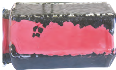
Ulike eksempler som viser unik svellekapasitet inn i små porer, hulrom og mellomrom uten å miste kohesjon.
