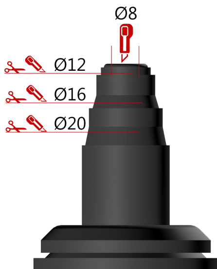
Kapping av rørgjennomføring
