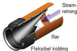
Montering på utløp vha fleksibel kobling.
