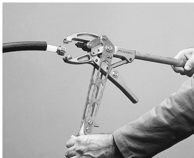
5. Åpne monterings-tangen. Røret med kuplingen frigjøres automatisk og er ferdig til å monteres på fordeler eller veggboкс.
