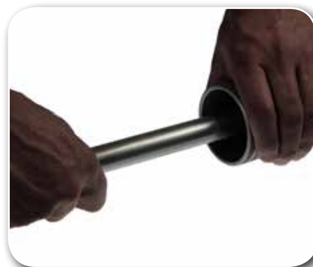
Figur 5: Avgrading av røret
