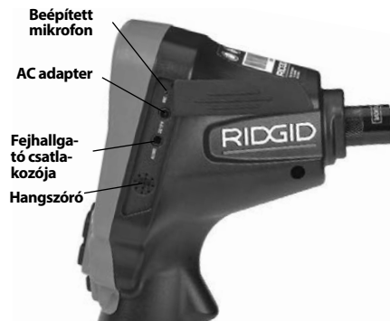
3. ábra – Jobb oldali csatlakozó-burkolat
