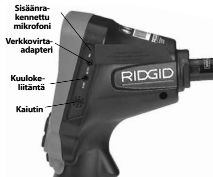
Kuva 3 - Oikean puolen portin suojus
