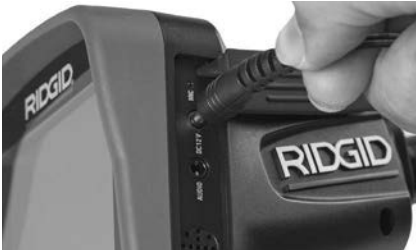
Rys. 6 - Zasilanie zespołu z zasilacza prądu przemiennego
