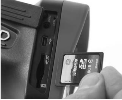
Şekil 9 - SD Kartın Takılması
