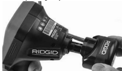
Slika 18 - Montirani priključni utikač kamere
