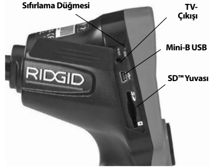
Şekil 4 - Sol Yan Bağlantı Noktası Kapağı
