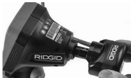
Obrázok č. 18 - Zasunutie konektoru kamery
