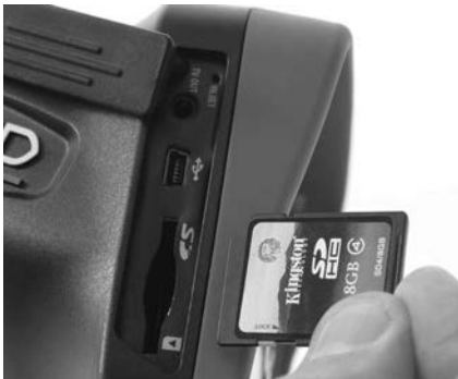
9. ábra – SD-kártya behelyezése
