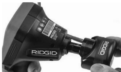
Figura 18 - Fișa conectorului a camerei instalată
