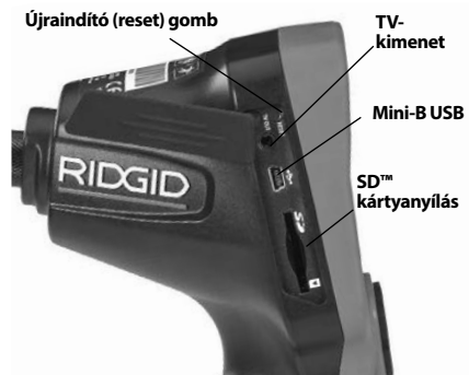
4. ábra – Bal oldali csatlakozó-burkolat
