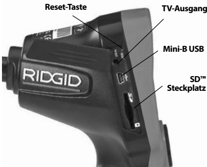
Abbildung 4 - Anschlussabdeckung auf der linken Seite
