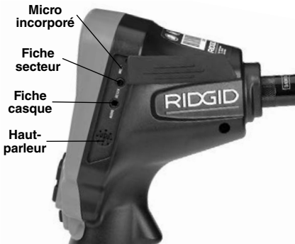
Figure 3 – Branchements côté droit
