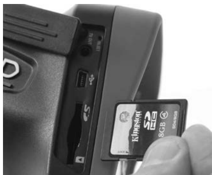
Slika 9 - Umetanje SD kartice
