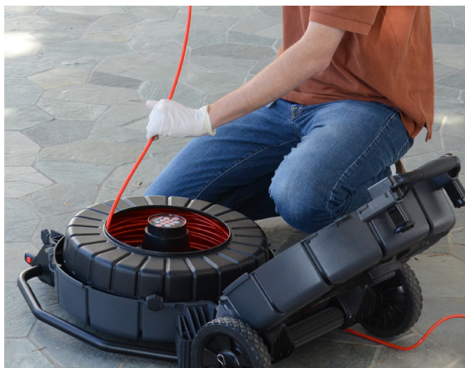
Figur 27 – At føre skubbekablet ind i tromlen
