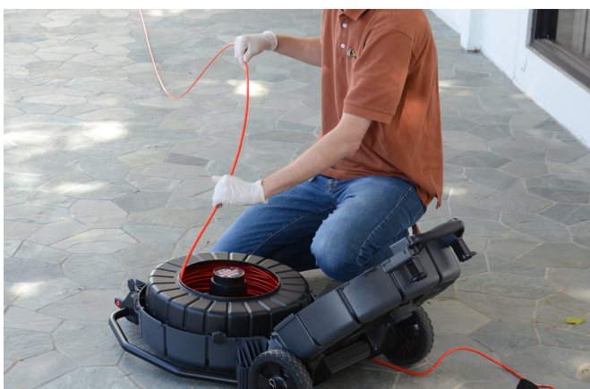
Figur 26 – Rotering af tromlen for at vikle skubbekablet korrekt.
