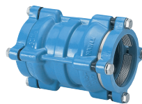
Skjøtemuffe DN 50-350 Ved å fjerne stoppringen kan den brukes som glide- muffe.
