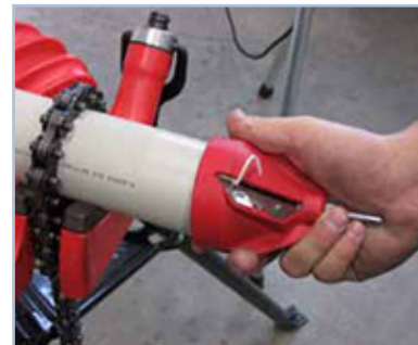
Fase enden av røret.
