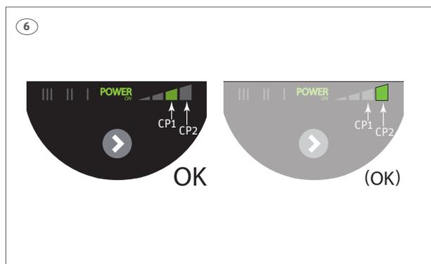
**(DK)** Fejl, som kan hindre pumpens drift (fx blokering), vises ved, at der kun er lys i "POWER ON"-lysfeltet. Hvis der vises en fejl, ret fejlen, og afstil (reset) pumpen ved at afbryde og tilslutte forsyningsspændingen.
