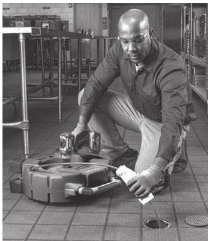
Figur 10 - Påføring av smøremiddel på kabelmantelen
