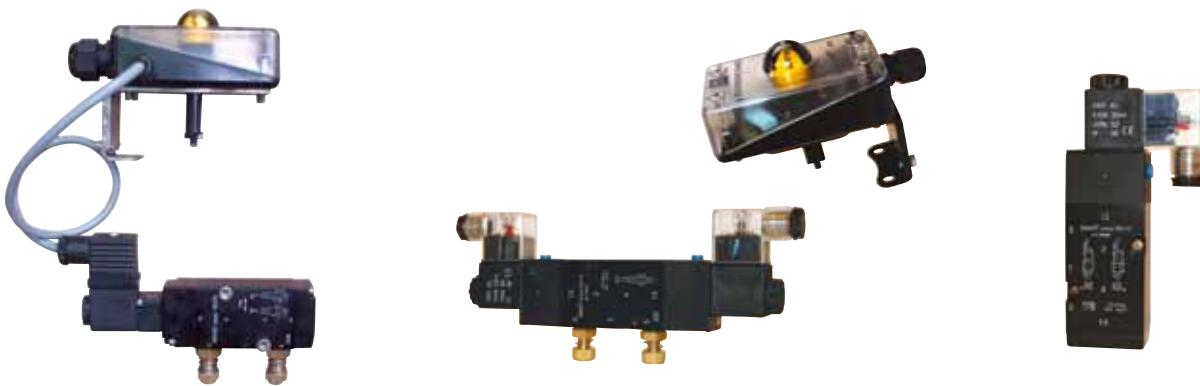
Magnetventiler leveres med Namur tilkobling for direkte montering på pneumatiske aktuatorer, og kan leveres monostabil og bistabil. Strømstrek er 230V AC og 24V DC
