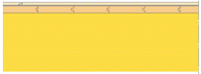
Fig 8.1. Konstruktion bestående av 22 mm Forestia Golv, Masonite Beams I-balk, mineralull, 22 mm Forestia Golv och Tak-ess.
