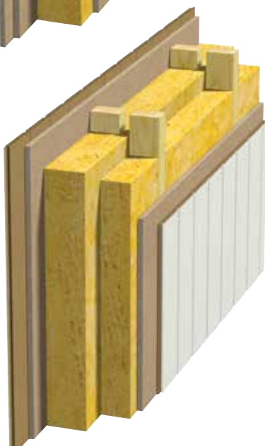
Fig. 4 Innvendig vegg. Dobbel heltre stender. To platelag.
