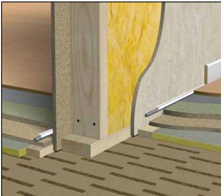
Gulv, mot innervegg
