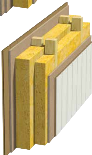
Fig. 4 Innvendig vegg. Dobbel heltre stender. To platelag.
