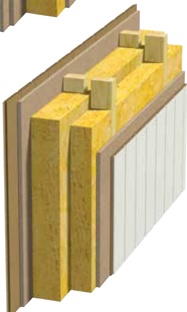
Fig. 4 Innvendig vegg. Dobbel heltre stender. To platelag.
