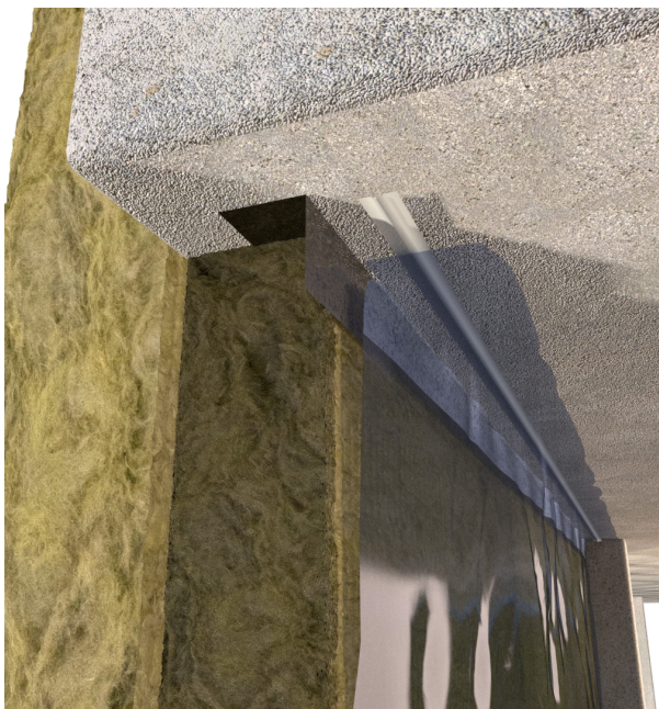
Montage av ångspärr mot betong
