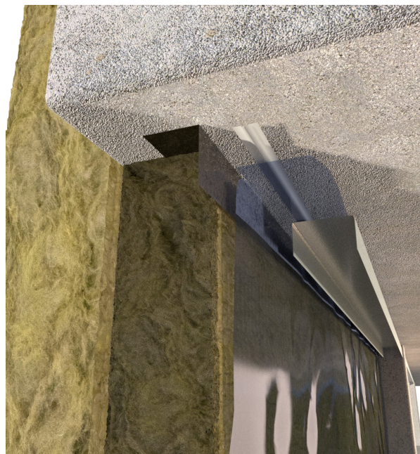
Mekanisk säkring av ångspärr
