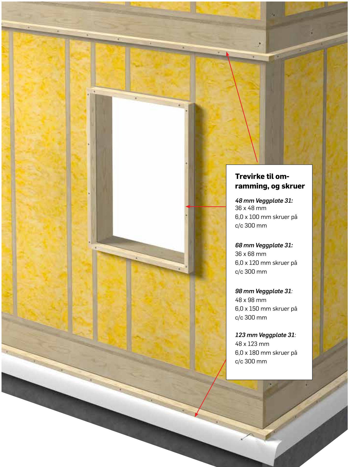
Omramming ferdig montert
