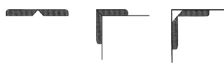
Fig. 5 Utvendig hjørnelist / Exterior corner moulding
