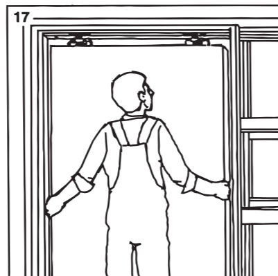
17 Häng dörrbladet på plass i hjulbeslagen. Hæng døren på plads i vognhjulene. Heng dørrbladet på plass i vognhjulene.
