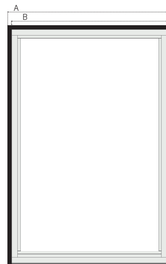
Fig 9. A) Mål på veggåpning B) Karmens yttermål
