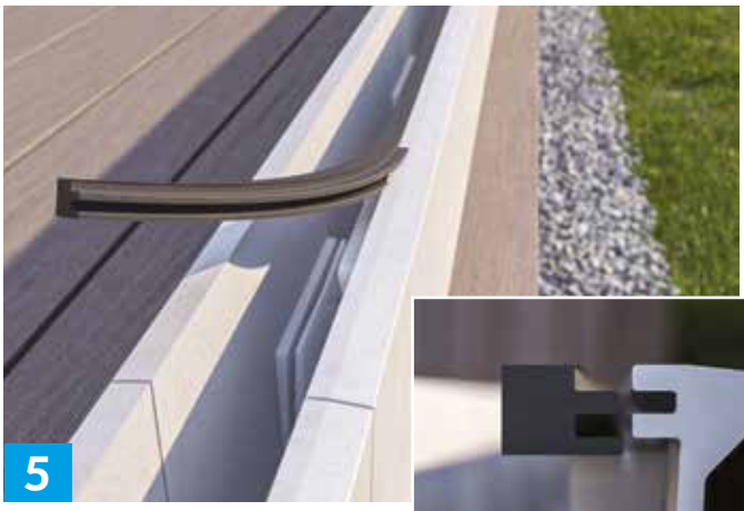
5 Monter den utvendige gummipakningen. Pakningen "rulles" på. Unngå skjøt mellom to monterings Skinner. For enklere montering kan litt såpevann benyttes.
