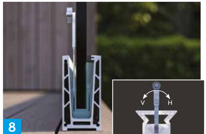
8 Glassene finjusteres med justeringsverktøyet inntill ca +/- 8 mm i topp. Venstre innover, høyre utover.
