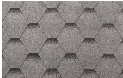
Fig. 2 Takshingel Pro og Premium – skrå hjørner. Bredde: 1,0 m oppdelt i 3 tunger. Hver shingelrad bygger 134 mm Figur: BMI Norge AS
