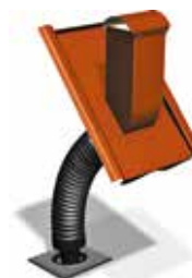
Avløpsluffer stål Komplett avløpsluffer i stål. Stillbar etter takvinkel 14-45°. Ved lett undertak må monteringsbeslag bestilles.
