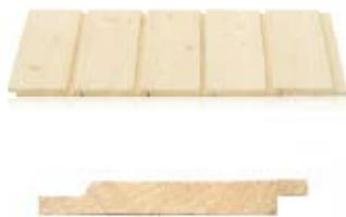
Som det fremgår av navnet er denne kledningen nært beslektet med Dobbelfals Gammel type. Den skrå kanten på Dobbelfals Ny type er 60 grader, og har derfor en rettere kant i falsen enn den Gammel typen.
