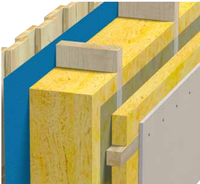
Fig.40 Yttervegg med inntrukket dampsperre
