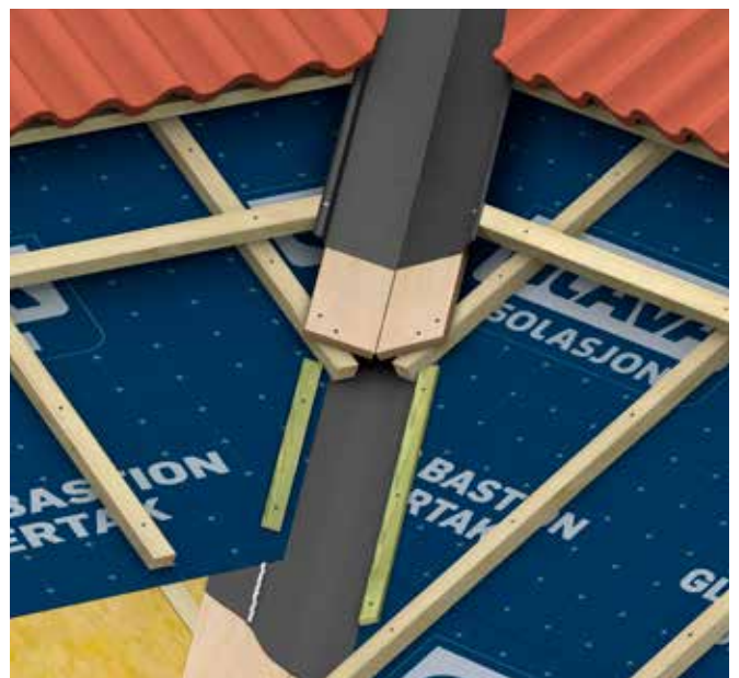
Fig. 19 Prinsipp for kilrenne med kilrennemembran
