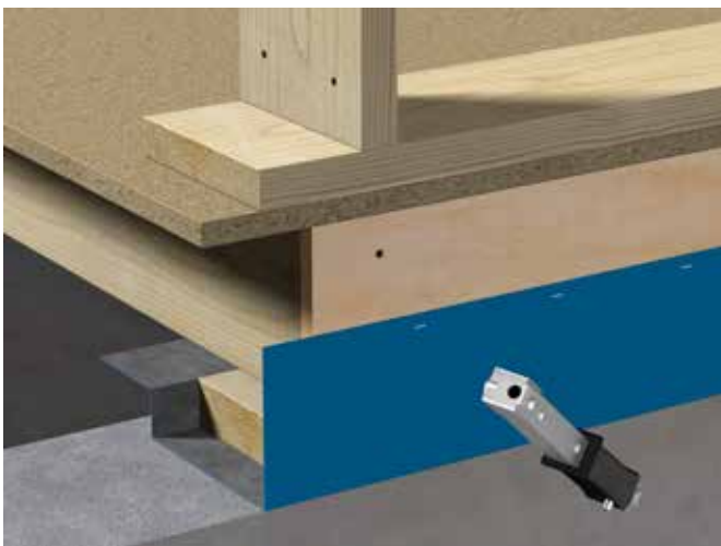
Fig. 24 Svillemembran med to lepper
