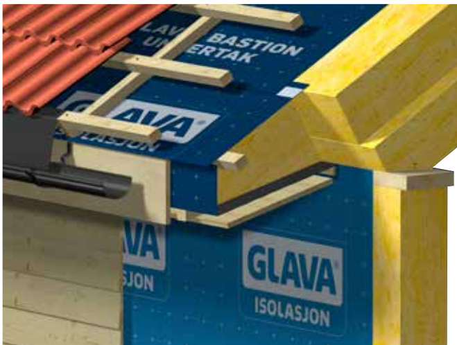
Fig. 14 Prinsipp ved utstikkende sperrer
