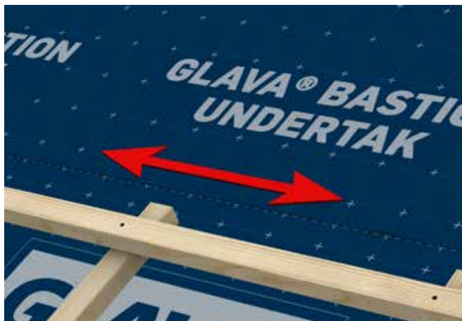
Fig. 9 Utstryking av omlegg
