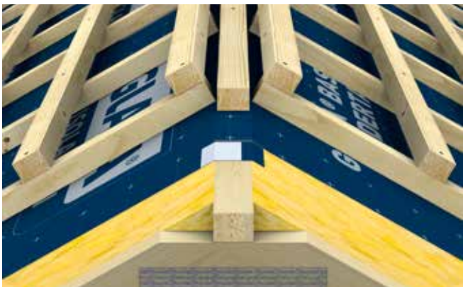
Fig. 17 Prinsipp for avslutning i mønet
