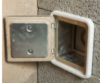
Pass på at den innvendige rammen på sotluken skyves inn mot rammen på sotlurerøret. Deretter monteres medfølgende dørstein. Påfør fugekitt mellom rammene for optimal tetthet.
