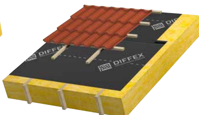
Luftet konstruksjon med AeroDek stålpanner over Icopal diffusjonsåpent undertak, lagt rett på taksperrene.
