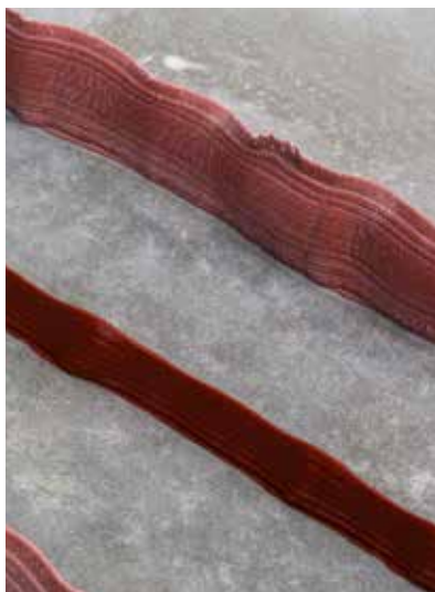
Produkt i normal og i svellet tilstand etter kontakt med vann.
