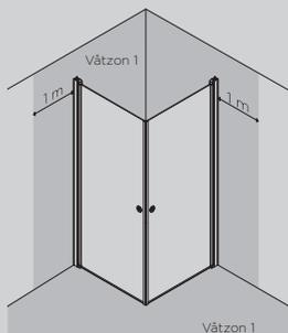
Skruvfästningar i våtzon 1 ska göras i betong eller annan massiv konstruktion (a), träreglar, träkortlingar (b) eller i konstruktion som är provad och godkänd för infästning, till exempel skivkonstruktion (c). Se exempel på godkända konstruktioner på säkervatten.se. Alla infästningar i våtzon 1 och 2 ska tätas. Material för tätning ska fästa mot underlaget och vara vattenbeständigt, mögelresistent och åldersbeständigt.
