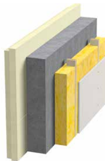
fig.9. Kjelleryttervegg med betong
