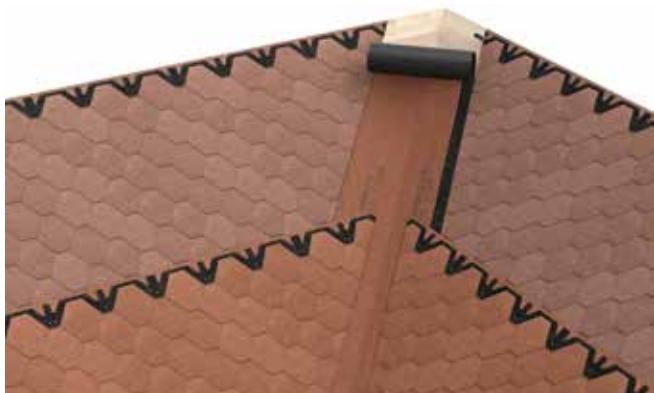
Skjær bort all gammel shingel og kilrennebelegg i ca 50 cm fra senter av kilrenne. Legg ut nytt kilrennebelegg Isola Mestertekk/ Isola Selvbygger i hele kilrennens lengde. Stift belegget i ytterkant. Kleb kilrennebelegget til takfotbeslaget. Legg ut to stripere fugemasse langs kanten i full høyde. Monter shingel med min. 25 cm overlapp inn på nytt kilrennebelegg. Festes i klebefeltene.
