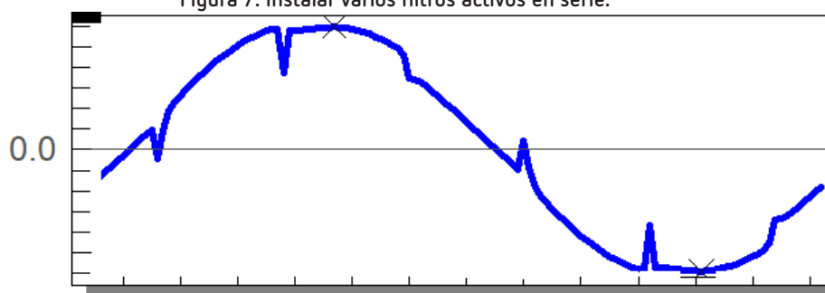
Figura 8: Ejemplo de muescas (notches) severas en la tensión de red.
