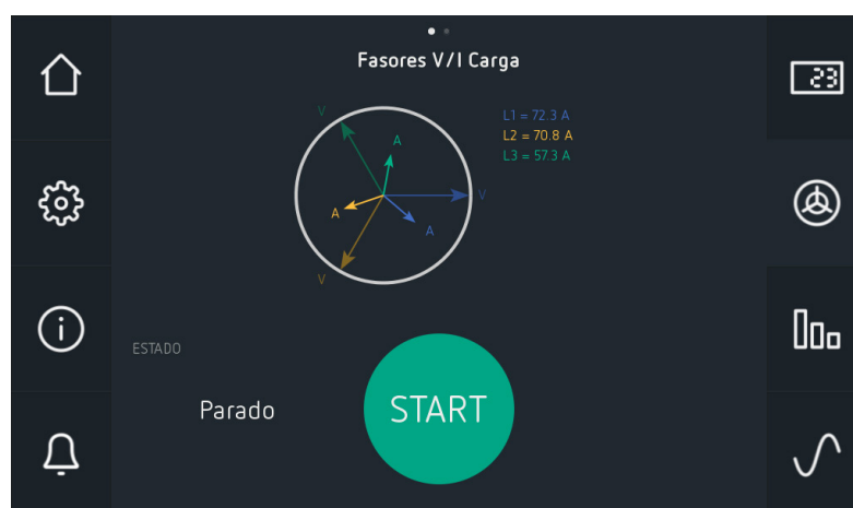
Figura 56: Fasores de Carga.
