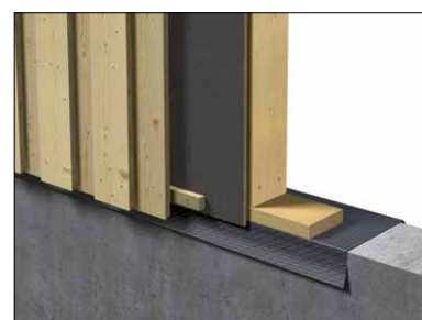
Overgang mur og vegg
