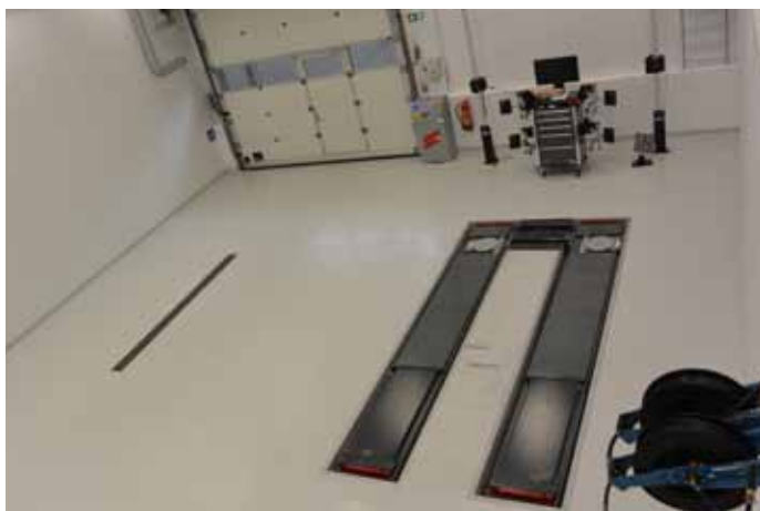
Hjulstillingsplass med VAS 6804 kjørebaneløfter fra MAHA og VAS 701 001 hjulstillingsapparat fra Snap-on.
