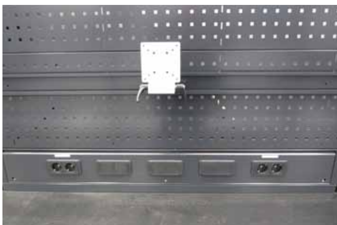
Strøm og stikkontakter integrert i bakvegg/verktøytavle. Skinner med holder for PC-skjerm er montert på verktøytavlene.
