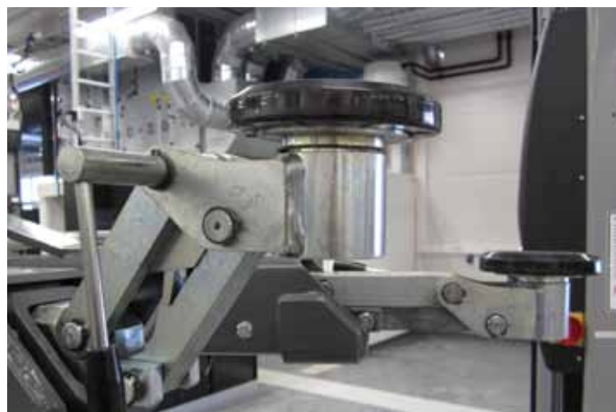
Rotary 3.5 tonn hydrauliske løftere. Alle er utstyrt med flip up-konsollarmen som gir mulighet for hurtig trinnsvis plassering av løftepads mot kjøretøyets løftepunkter.
