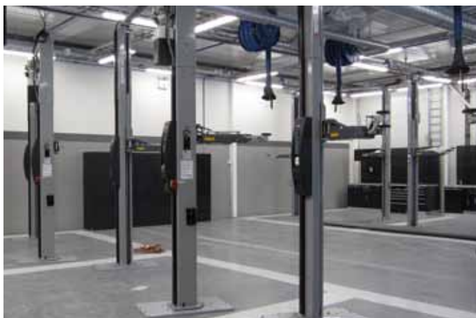
Rotary 3.5 tonn hydrauliske løftere. Alle er utstyrt med flip up-konsollarmen som gir mulighet for hurtig trinnsvis plassering av løftepads mot kjøretøyets løftepunkter.
