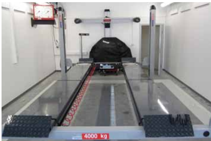
PKK-plass med Stertil-Koni ST4040 4-søylers, Altus RT2002 bremseprøver og John Bean hjulstillingsapparat.
