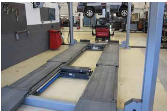
MAHA elektrohydraulisk 4-søyler for hjulstilling. Løftekapasitet på 5.5 tonn og kjørebanelengde på hele 5.520 mm. er tilstrekkelig for rulle-kompensering av selv de lengste kjøretøyene.
