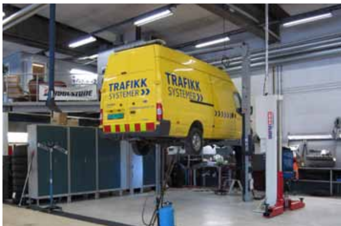
To av Rotary-løfterne er i ekstra høy utgave. Dermed får man løftet også de høyeste varebilene høyt nok.
