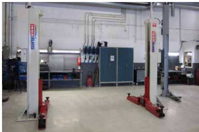
Stertil-Koni 2-søyler med hele 9 tonn løftekapasitet for de aller tyngste kjøretøyene.
