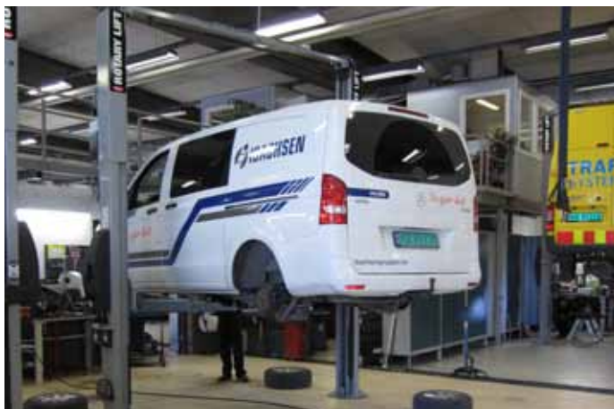
Rotary 2-søyler med 4.5 tonn løftekapasitet for de "vanlige" arbeidsbilene.
