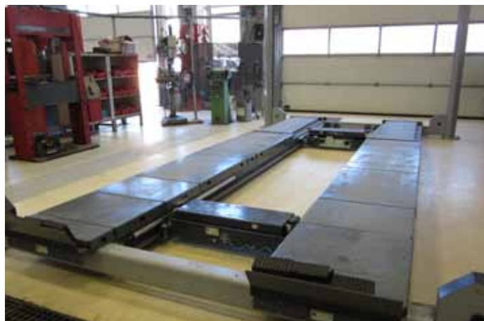
MAHA-løfteren har svært høy presisjon på nivellering/låsing av kjørebaner. Sammen med forsterkede kjørebaner betyr dette en robust og slitesterk konstruksjon for ekstra lang levetid.
